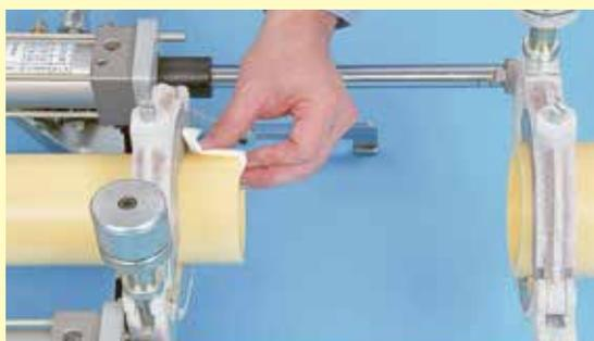
●管の外面と継手の内面を、アセトンを染み込ませた清潔な**紙ウエス**又は**ガーゼ**で清掃して下さい。
