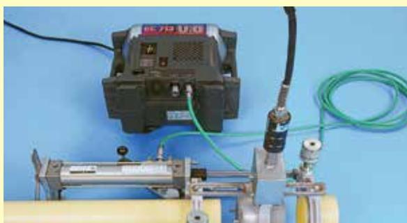
●レバーを操作して管と継手の間にヒーターを装着します。
