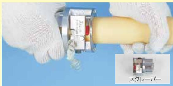
●スクレーパーにパイプを挿入し、刃の2分の1以下に管端をセットします。スクレーパーを右回りに回転させ“**当たり**”に到達すると刃先が管から離れます。
