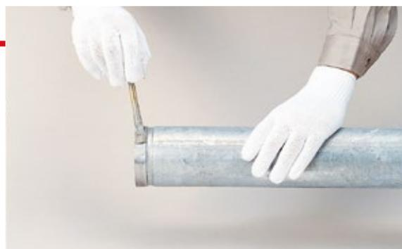
※の塗装箇所は継手接合後において、塗装の有無を確認する目的のため行います。従って、この箇所の塗装については、ユーザー様と打ち合わせの上、決めて下さい。
