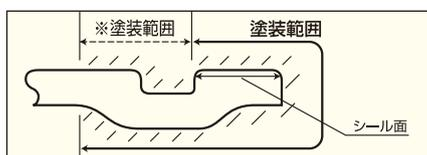
(注意) 工期の長い物件で水張り、水抜き後、長期間放置するとパイプ端面の発錆による漏れが出る恐れがありますので防錆塗装を必ず厳守して下さい。
